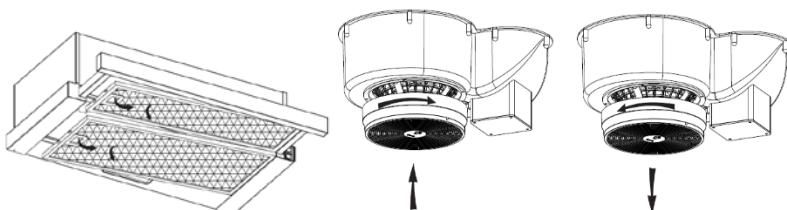
Установите угольный фильтр на моторе и поверните по часовой стрелке для закрепления. Тоже самое сделайте с другой стороны мотора
